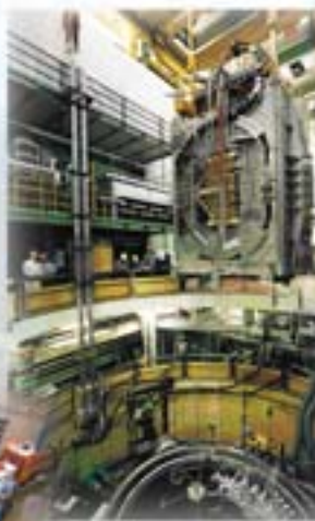
Provning av en modellindning för toroidalfältet
